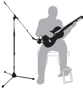
Illustration 8: Guitare sèche avec un C414 unique
