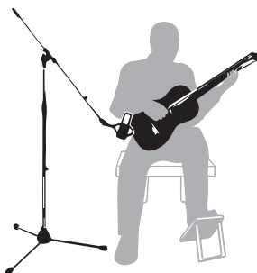
Abbildung 8: Akustische Gitarre mit einem C414
